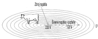
Obr. 68: Šírenie krokového napätia
