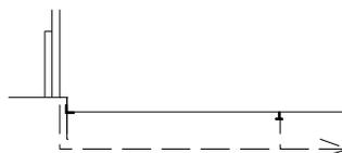
Obr. 70: Osadenie vodiacich profilov v krmisku a ich uzemnenie
